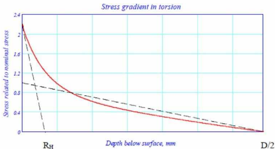
그림 19 깊이의 함수로서의 크랭크핀 필릿부의 비틀림 응력집중계수 (저널 필릿부에 해당하는 응력집중계수는 R_H 를 R_G 로 바꾸고 D 를 D_G 로 바꾸어 알 수 있다.)
